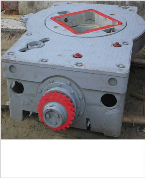
Ротор Р-360 Ш14М 360 – диаметр отверстия в столе Ш – со штанговым центратором 14 – диаметр штангового центратора М – модернизированная версия
