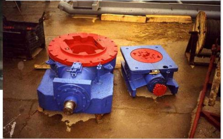
Ротор Р-360 Ш14М 360 – диаметр отверстия в столе Ш – со штанговым центратором 14 – диаметр штангового центратора М – модернизированная версия
