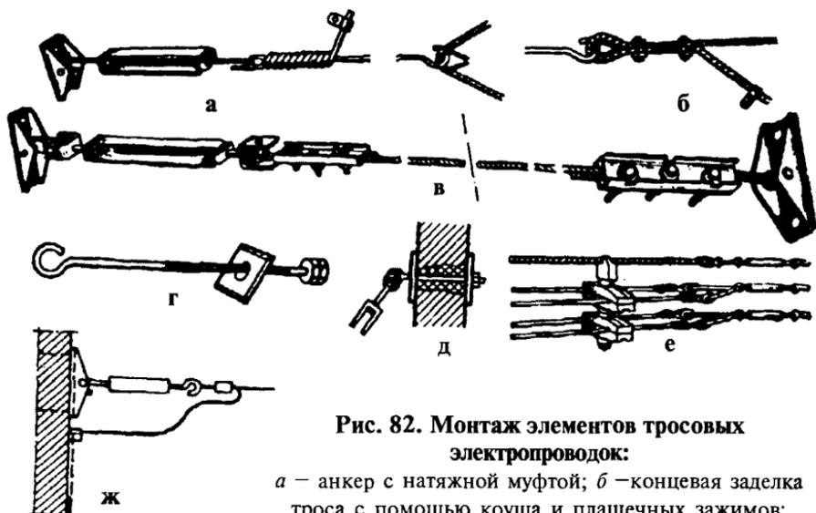
**Рис. 82. Монтаж элементов тросовых электропроводок:**
