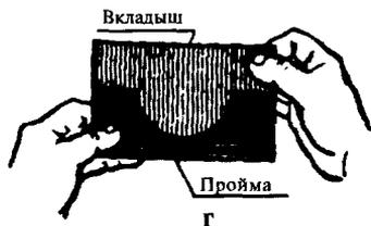
**Рис. 32. Взаимная пригонка деталей (припасовка) при открытой пройме:**
