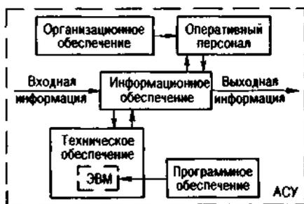
Рис. 8.3. Схема взаимодействия основных компонентов АСУ ТП
